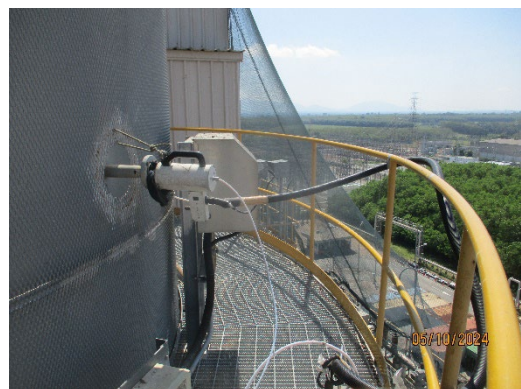
ภาพที่ 3.2-1 แสดงการตรวจวัดคุณภาพอากาศจากปล่องระบาย ในวันที่ 5 ตุลาคม พ.ศ. 2567
